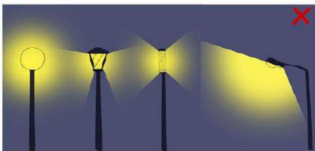
Diffusion lumineuse de différents types de mobilier d'éclairage traditionnels. On observe une déperdition lumineuse plus ou moins importante à l'origine de la nuisance lumineuse.
